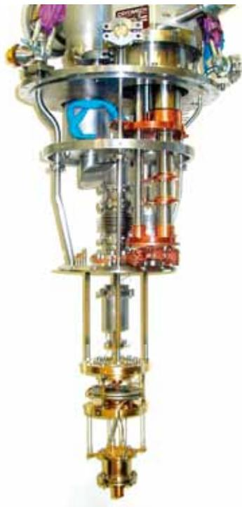
Réfrigérateur à dilution 10 mK fonctionnant sans fluide cryogénique
