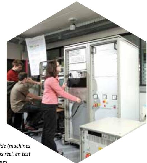
*Banc de simulation hybride (machines virtuelles et réelles) temps réel, en test sur des modèles d'éoliennes*
