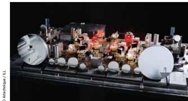
Interféromètre de résolution angulaire de  $10^{-9}$  pour la vérification de l'équivalence énergie-matière :  $E = mc^2$
